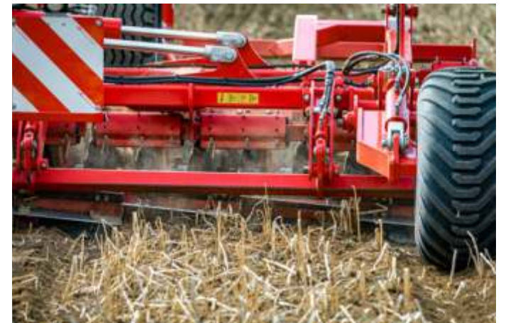
Bıçak tamburu, ek parçalama için tasarlanmıştır
