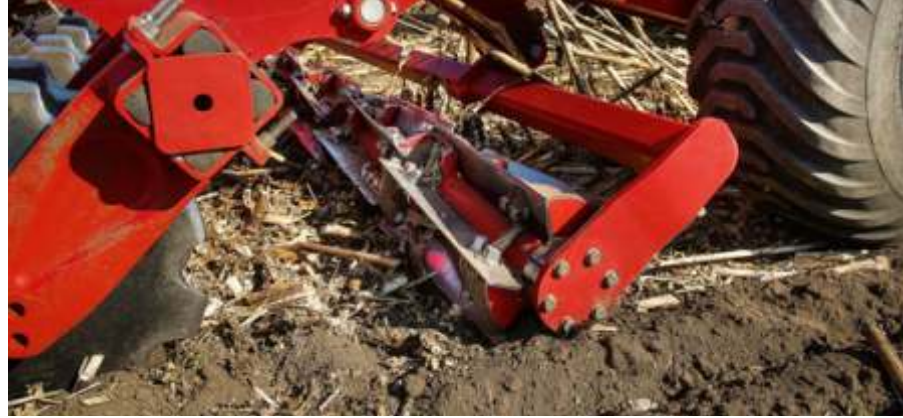
Opsiyonel olarak ek parçalama etkisi için hidrolik ön gerilimli bıçak silindiri
