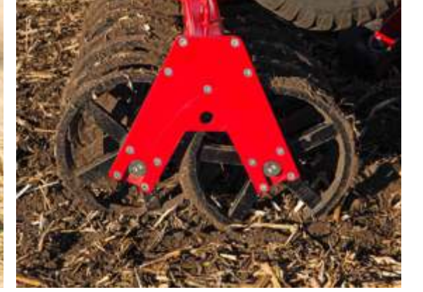
Sabit çift merdane şasisi ile yüksek kendini temizleme özelliği
