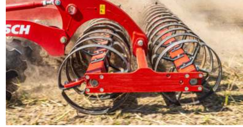
Optimum zemin takibi için salınlı çift merdane şasisi
