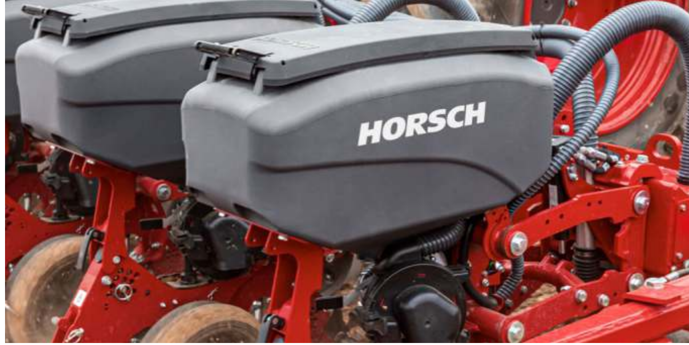
Ünite başına 70 l hacmi ile tohum haznesi
