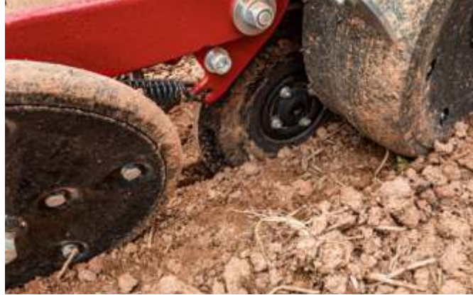
Tohum baskı tekeri, iyi bir tohum-toprak birleşimi için büyük öneme sahiptir.
