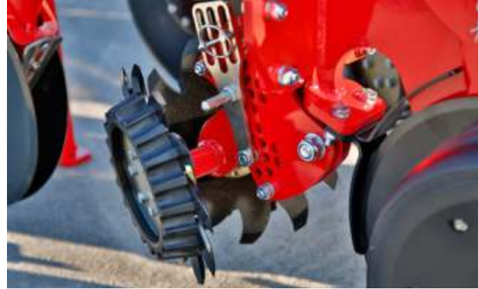
Opsiyonel temizleme yıldızları, derinlik yönlendirme ile çalışabilir.
