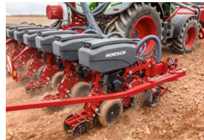
Hidrolik baskı ayarı ile optimum gömme
