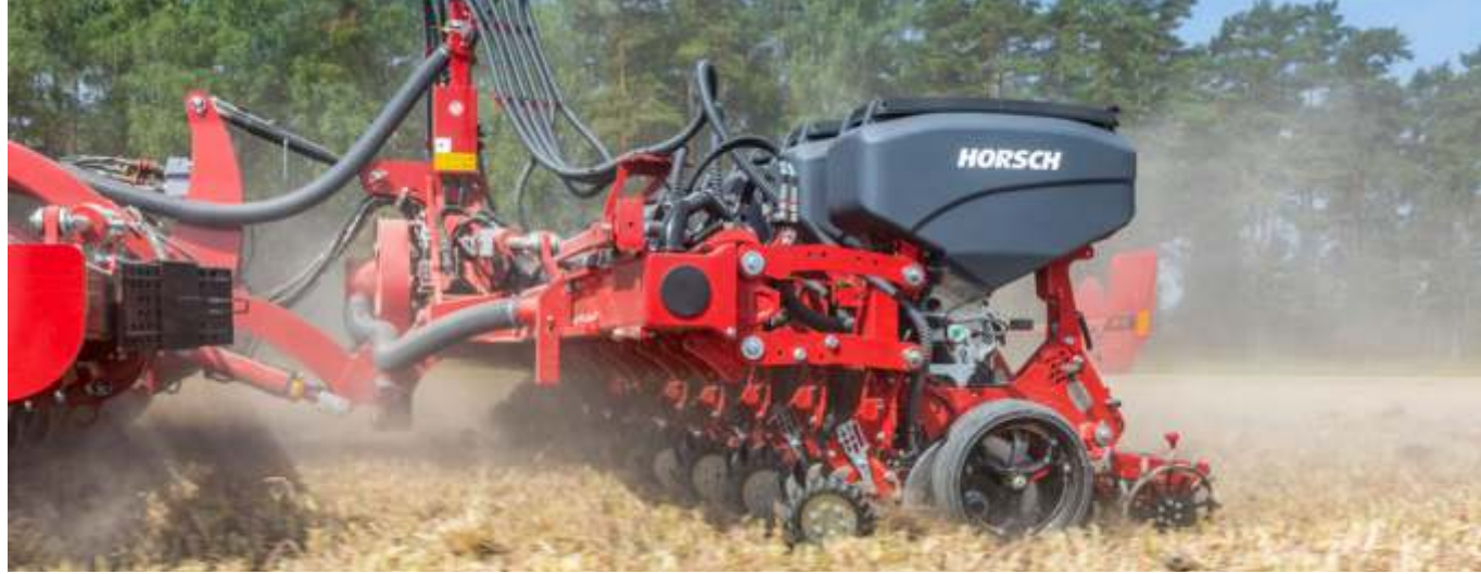
Tohum ekim ünitesi, 350 kg'a kadar ekstra baskı kapasitesine sahiptir.
