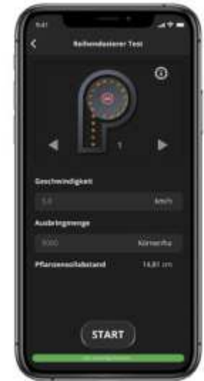
HORSCH Control uygulaması sayesinde, tekleme kalitesine ilişkin en önemli parametreler, her bir sıra bazında istenilen zamanda test edilebilmektedir.
