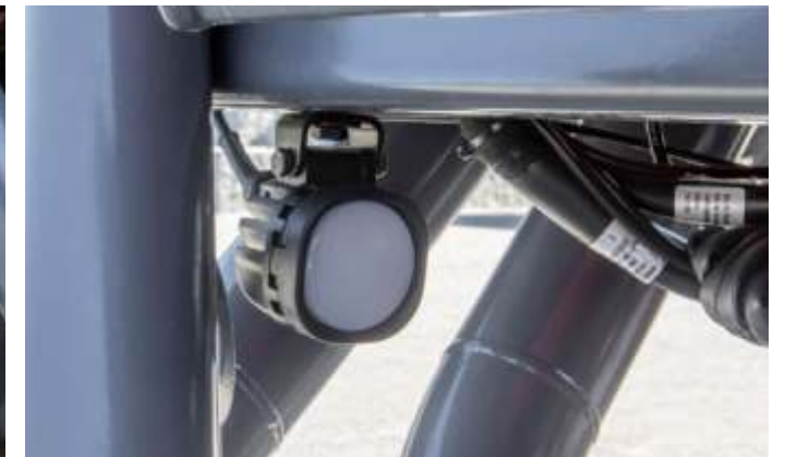
Kalibrasyon işlemini rahatça yapılabilmesi için dozaj ünitesinin aydınlatılması
