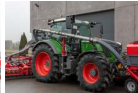
Yatay borulama eki, minimum görüş kısıtlamalarını garanti eder
