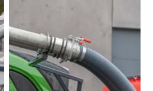
Hızlı bağlantılar, ön tank, traktör konsolu ve ekipman arasında hızlı bağlama ve ayırmayı kolaylaştırır
