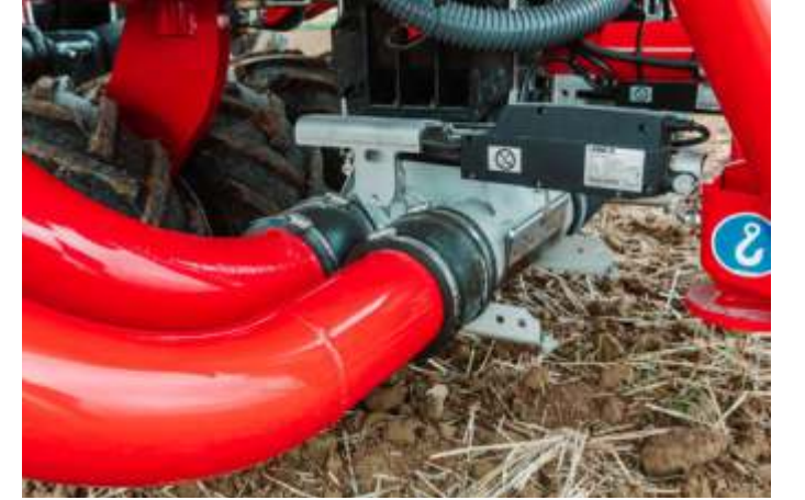
Elektrikli yarım genişlik kapatma sistemi, terminal üzerinden tek tuşla yarım genişliğin kolayca açılıp kapatılmasını sağlar
