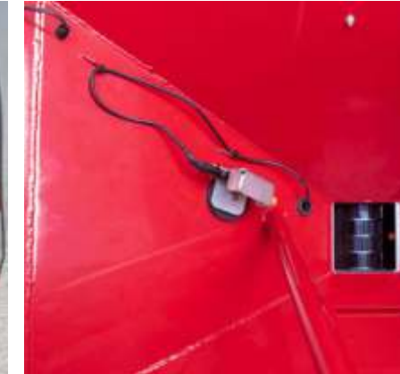
2 seviye sensörü biri tankta yüksekliği ayarlanabilir, diğeri doğrudan dozaj ünitesi üzerinde
