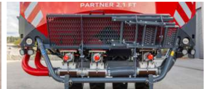
Partner 2.1 & 2.5 FT Üç bölmeli tank ile: 3 bileşene kadar 3 bağımsız dozaj ölçümü
