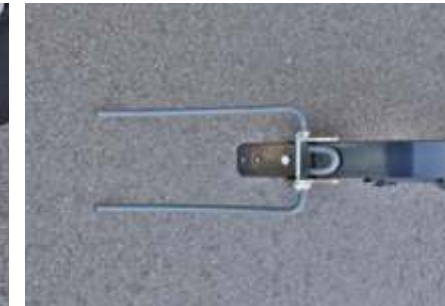
Düz tırmık ç TurboDisc-sisteminde, daha verimli bir toprak işleme için bireysel olarak ayarlanabilir
