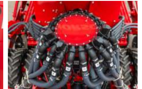
Dağıtım kulesinden pnömatik akışın takip edilmesi
