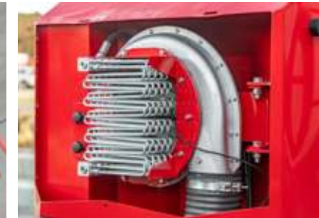
Sistemdeki yağ sıcaklığını düşürür ve traktörün yağ soğutucusunu rahatlatır
