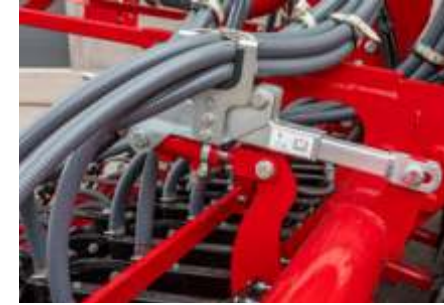
Traktör kontrol ünitesi üzerinden ekim ünitesi basıncı artırılabilir
