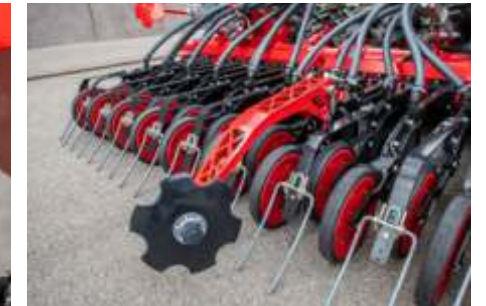
Çıkış öncesi işaretleyicinin ne kadar derin çalışacağı, derinlik sınırlayıcı ile kolayca belirlenir.
