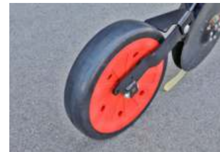
ParaDisc ekim sistemi ç 7 cm genişliğinde baskı tekeri
