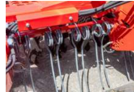
Tırmık, DiscSystem ile lastik merdane arasına konumlandırılmıştır. Ayar, mekanik olarak tasarlanmış çoklu delik yapısı sayesinde kolay ve güvenilir şekilde gerçekleştirilir.
