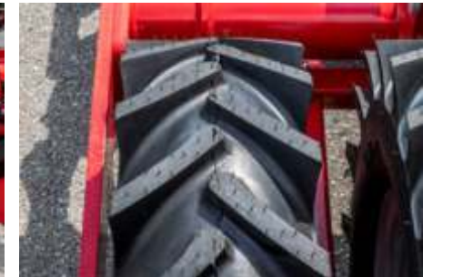
Düz lastik profili, kenar bölgesinde geri sıkıştırmayı artırır
