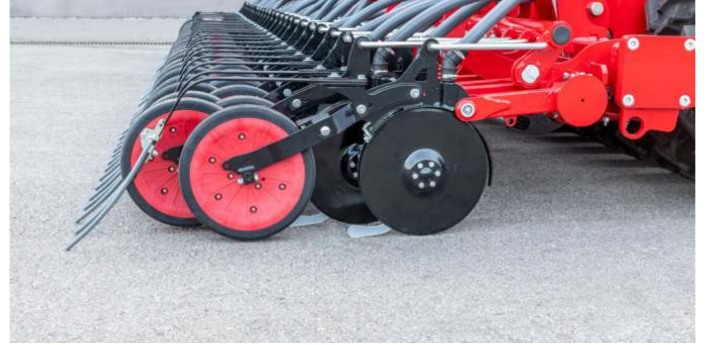
ParaDisc ekim sistemi ç 150 kgüa kadar baskı mümkün
