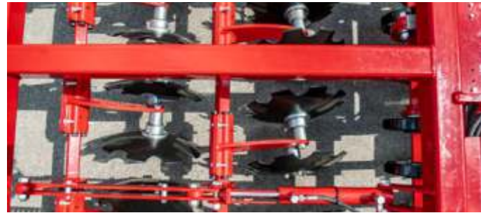
DiscSystem Pronto DC ç 46 cm çapında tırtıklı profilli diskler
