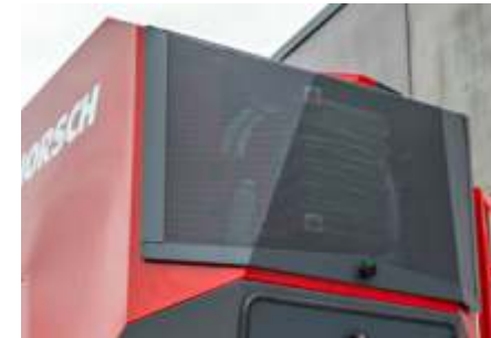
Hidrolik fan üzerinde bulunan yağ soğutucu pnömatik sistemdeki hava akışını ısıtır
