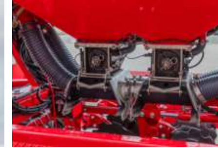
Çift hazneli G&F sistemi, farklı bileşenleri ayrı ayrı dozajlayarak tohum yatağına birlikte yerleştirir.
