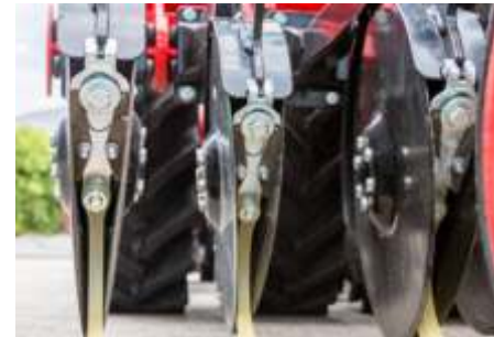
Hareketli sıyrıcı, nemli koşullar altında yüksek kendi kendini temizleme garantisi verir. Hareketli sıyrıcı, nemli koşullarda yüksek düzeyde kendi kendini temizleme özelliğine sahiptir
