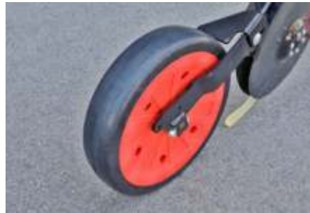
7,5 cm genişliğinde baskı tekeri ç hafif topraklar için ideal
