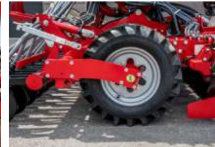
Lastik çapının büyük olması nedeniyle beygir gücü gereksinimi düşüktür ve sıyrıcıya gerek yoktur.
