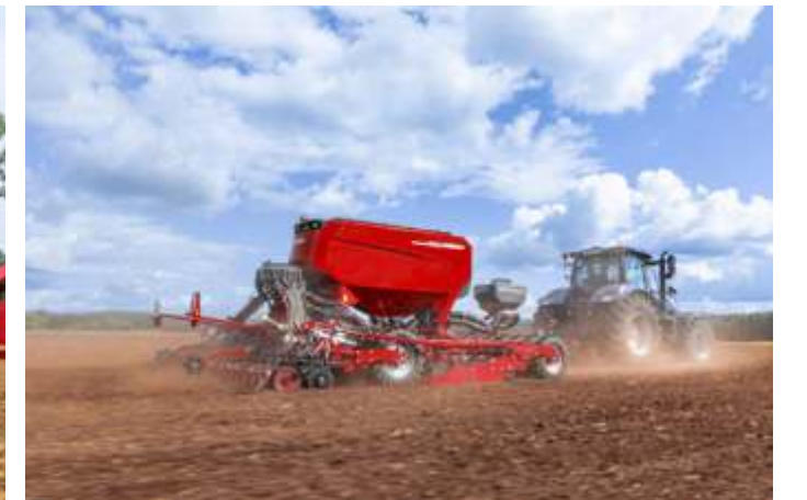
PPF Çift tank sistemi, 2 bileşenin 2 farklı derinlikte ayrı ayrı dozajlanmasını ve yerleştirilmesini sağlar
