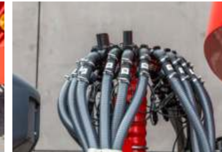
Gübre ve tohum akış kontrolü ç Tohum ve gübre hortumlarının sürekli takibi için
