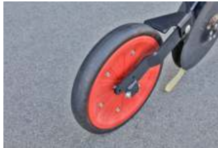
5 cm genişliğinde baskı tekeri ç orta ila ağır topraklar için idealdir
